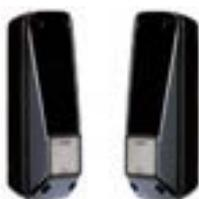
Barrera infrarroja de hasta 20 metros que, al ser interrumpida, corta automáticamente el funcionamiento del automatizador. Posibilidad de uso inalámbrico en el transmisor con batería. Placa direccionable para una instalación precisa. Uso obligatorio de este dispositivo para todos los automatizadores, conforme a la normativa Inmetro 371 / 2009.
