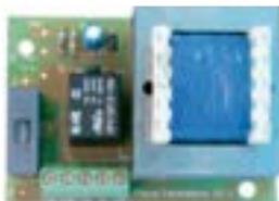
Permite el accionamiento de una cerradura, pestillo o cierre eléctrico con el mismo comando de apertura de la puerta. Cuenta con salidas de 127 Vca o 220 Vca, 12 Vca o 24 Vca (usar las dos salidas de 12 Vca según ilustrado en el manual). Es importante habilitar el jumper FCH en las centrales Rossi.
