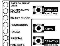
Para ativar as funções, pressione o botão **AJUSTE** até o LED indicativo da função acender, em seguida aperte o botão **ATIVA**. Para desabilitar repita o processo e pressione o botão **DESATIVA**.
